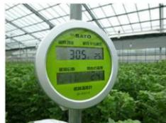
積算温度、積算日数、現在温度、前日平均温度を同時に表示し、稲刈りの判定目安、ハウス栽培の収穫判定の目安、花の剪定から開花の予想に使用できます。
